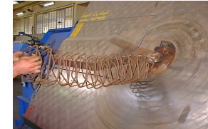
Παραγωγή σπλού συνεχόμενου σπειροειδούς συνδετήρα
